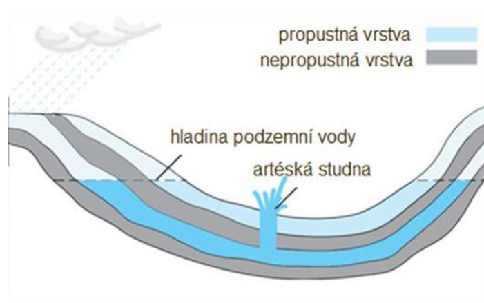
Obrázek 3.4 – Princip artéské studny 60
